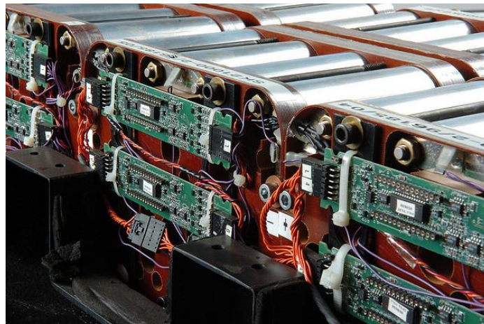
شکل ۵۹- نمایی از یک باتری متشکل از چندین سلول
