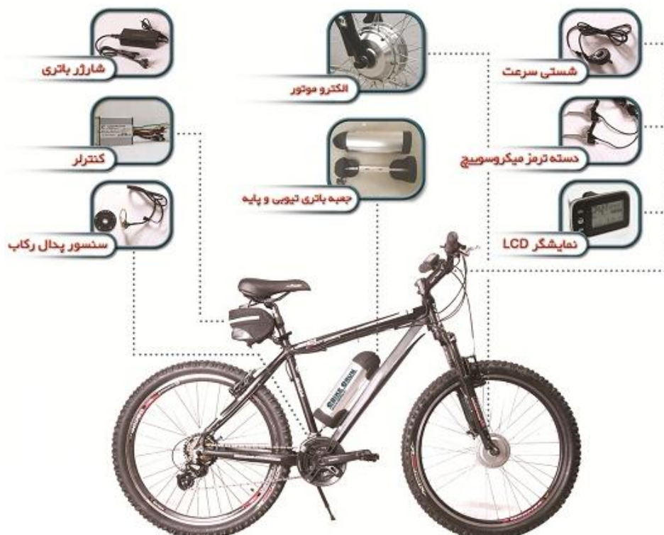
شکل ۴۸- تجهیزات لازم جهت تبدیل دوچرخه معمولی به دوچرخه برقی
