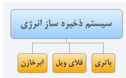
شکل ۹۰- سیستم‌های ذخیره ساز انرژی
