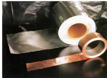
شکل ۱۱۱- فویل آلومینیومی و مسی که جمع‌کننده جریان در باتری است
