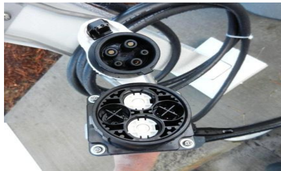
شکل ۸۶- کانکتور CHAdeMO در کنار کانکتور J1772
