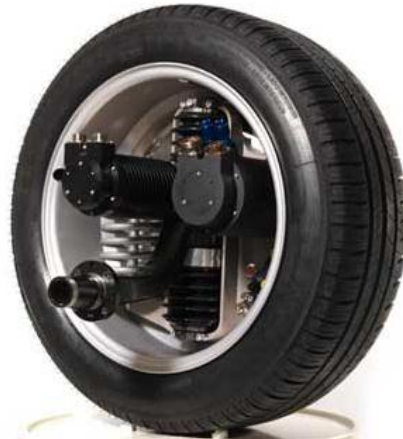
شکل ۷۳- تایر خودرو و موتور درون آن شرکت پورشه
