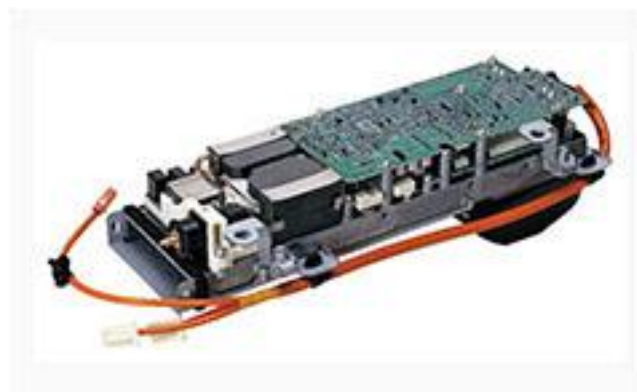
شکل ۶۳- کانورتر DC-DC مبدل ۴۰۰ به ۱۲ ولت
