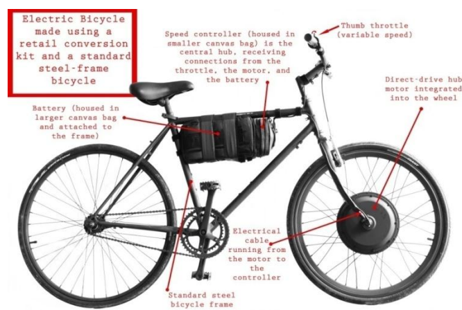
شکل ۴۲- دوچرخه برقی و اجزای آن
