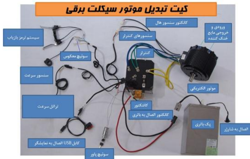
شکل ۵۰ - کیت تبدیل موتورسیکلت معمولی به موتورسیکلت برقی
