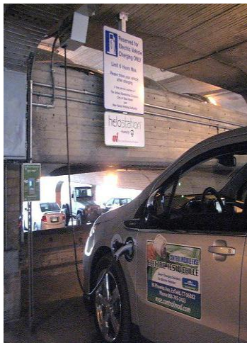
ب) ایستگاه شارژ عمودی با کابل جمع شونده
